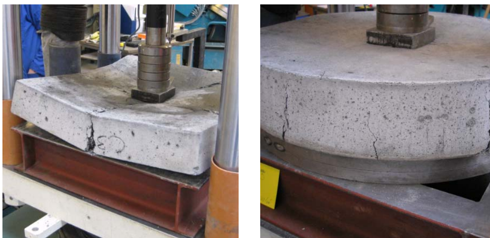
Mynd 1 - Mælingar á orkugleypni í 2000 kN brotpressu MANNVITS á ferköntuðu 600 mm sýni samkvæmt evrópska sprautusteypustaðlinum (myndin til vinstri) og á 600 mm kringlóttu sýni samkvæmt norsku sprautusteypu-leiðbeiningunum (myndin til hægri).
